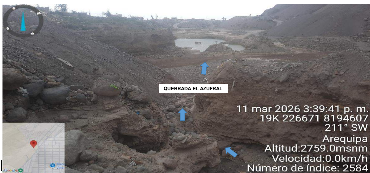
Imagen N° 3. Zona colmatada en el tramo, en donde se observa el estado de l cauce de la quebra El Azufra, debido a la extracción dee material de acarreo.
